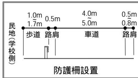
詳細な設置位置等は沿道の方々等との調整により確定。車道幅員5.0mは朝陽小学校前の概ね200mの範囲。
