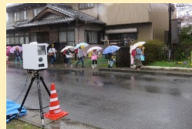
幅員が狭い道路でも活用できる「可搬式速度違反自動取締装置」を活用して、効果的な速度違反取締りを行い、速度規制の実効性を確保。
