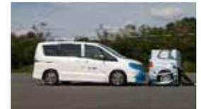
衝突被害軽減ブレーキの性能認定試験(イメージ)
