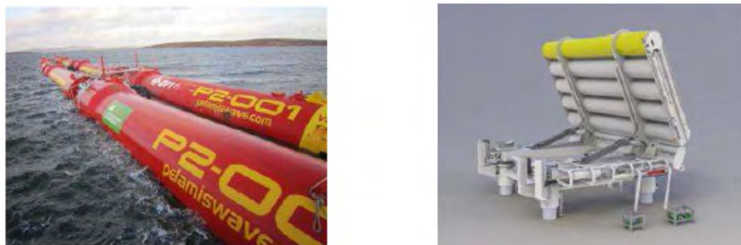
図 3 : Plamis 社と Aquamarine 社の波力発電装置
