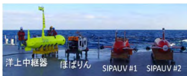
調査に用いた洋上中継器と 3 機の AUV (提供: 国立研究開発法人 海上・港湾・航空技術研究所海上技術安全研究所(海技研))
