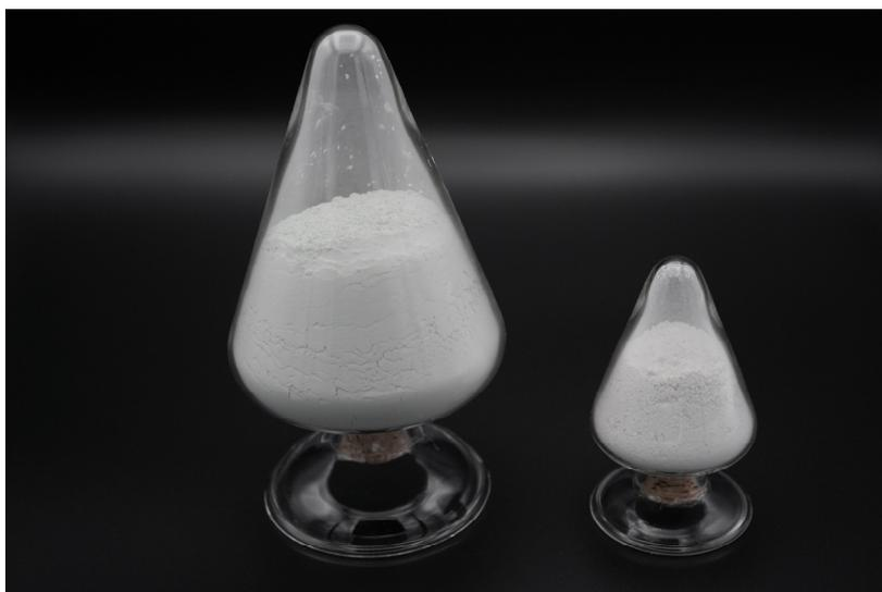
精製されたレアアース試料及び濃縮結果 (左) 精製物A、(右) 精製物B
