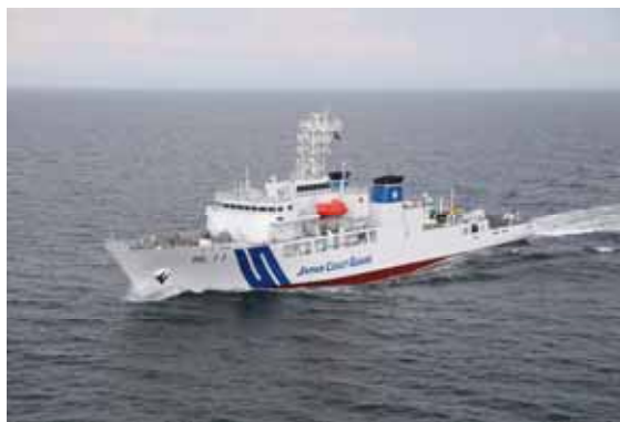
大型測量船「平洋」 海上保安庁海洋情報部所属 総トン数 4,000 トン・全長 103m
