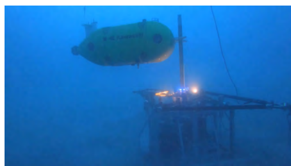
光通信と画像によって深海ターミナルのボールにドッキングする AUV
