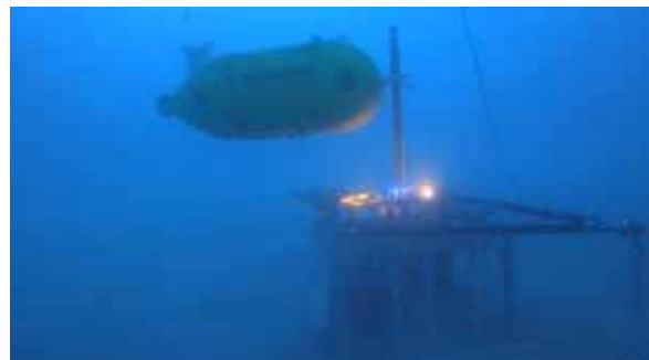
光通信と画像によって深海ターミナルのボールにドッキングする AUV
