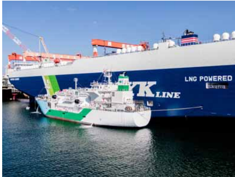
「かぐや」のLNGバンカリングの様子 （提供：セントラルLNGマリンフューエル株式会社）
