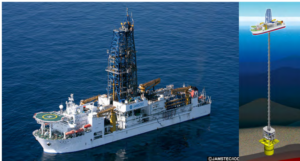
地球深部探査船「ちきゅう」とレアアース泥システム概念図
