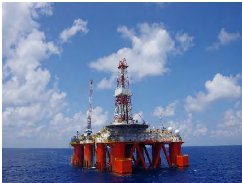
試掘調査で利用するセミサブマーシブル型リグ HAKURYU-5 提供：日本海洋掘削株式会社（JDC）
