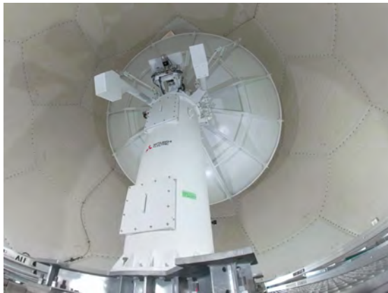
（左）二重偏波気象レーダー（右）海洋気象観測船によるCTD（海水の塩分、水温、圧力（深度）を計測するための観測装置）を用いた観測（提供：気象庁）
