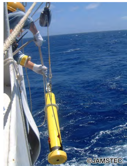
アルゴフロートを投入する様子 （提供：JAMSTEC）
