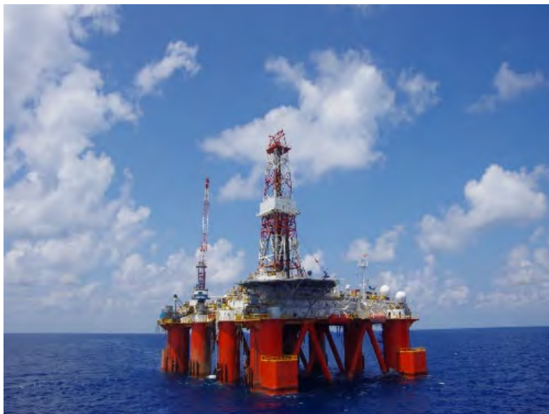
試掘調査で利用するセミサブマリーシブル型リグ HAKURYU-5 提供：日本海洋掘削株式会社（JDC）
