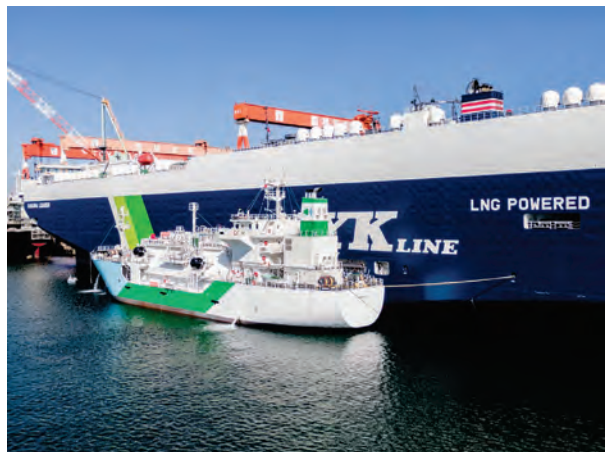
「かぐや」のLNGバンカリングの様子 (提供：セントラルLGM マリンフューエル株式会社)
