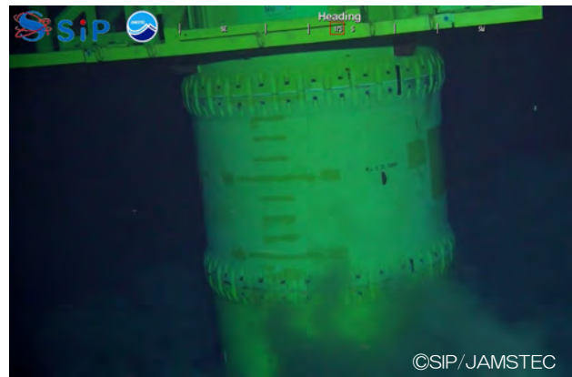
採鉱機の海底への貫入作業（1月30日） （提供：SIP/JAMSTEC）
