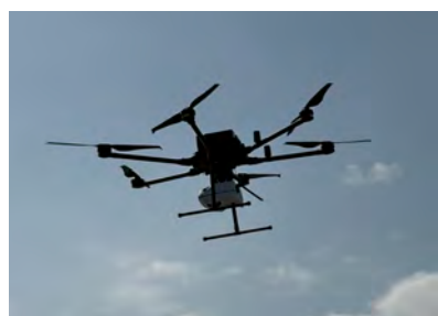
グリーンレーザー搭載ドローンによる藻場計測（提供：国土交通省）
