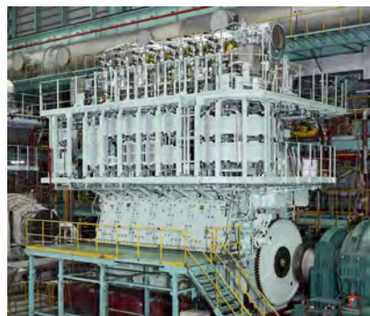
純国産の大型商用アンモニア燃料エンジン （提供：（株）ジャパンエンジンコーポレーション）
