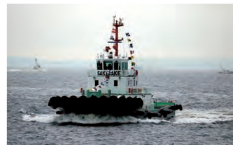
2015年に完成した日本初の天然ガス燃料船（タグボート）
