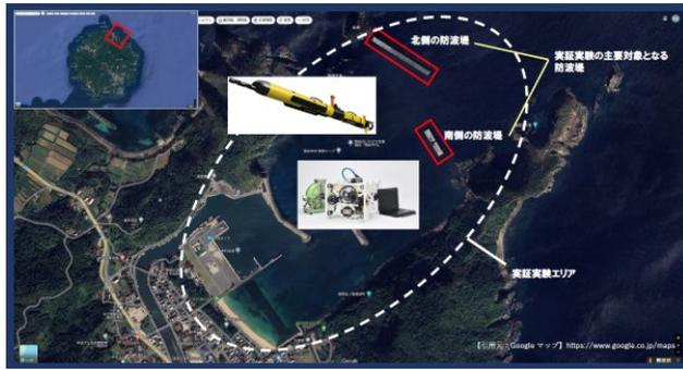
AUV を用いた水中インフラ構造物の3次元的な把握および評価(株式会社FullDepth)<sup>1)</sup>
