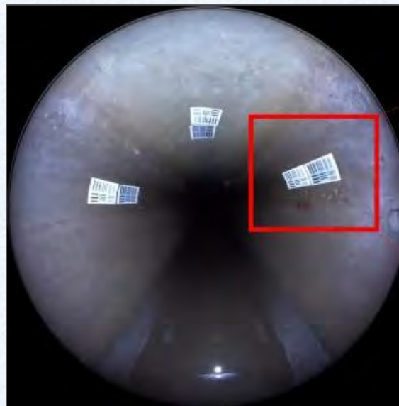
カメラユニットによる壁面撮影(バーコード読み取り試験)
