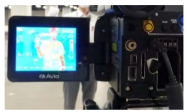
検温設備(サーモグラフィ)
