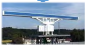
▲平均風速60m/sで安定運用可能な回転機構部へ換装
