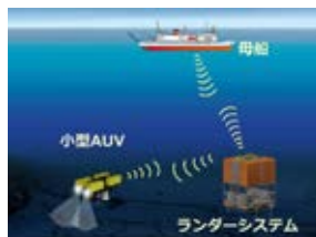
フルデプス対応試料採取探査システム概念図
