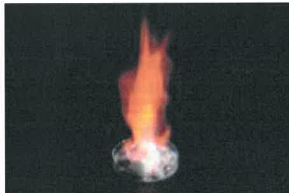
図 2-35 人工メタンハイドレートの燃焼実験
