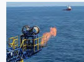
2013年3月、掘削船「ちきゅう」を用い、メタンハイドレートの世界初の海上産出試験に成功 (出所:MH21提供)
