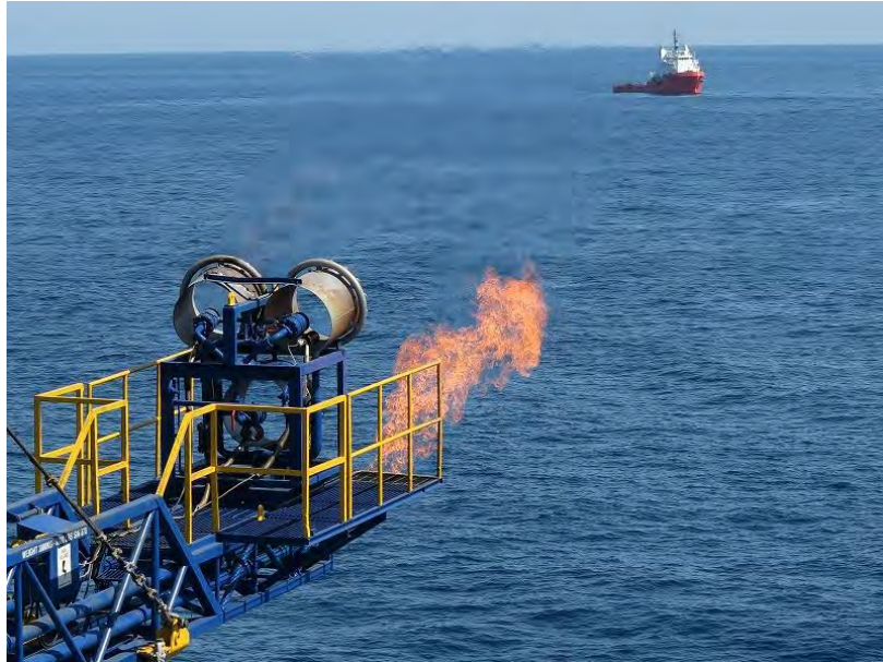
図 2-38 メタンハイドレート海洋産出試験の様子
