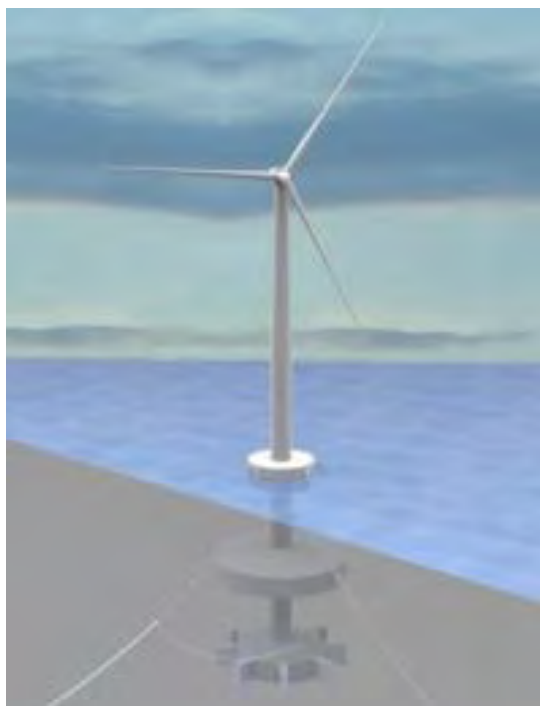
図 2-26 低動揺型洋上風車（スパー型）
