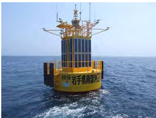
図 2-19 岩手県釜石沖の GPS 波浪計（写真提供：国土交通省東北地方整備局） （出所：気象庁（ http://www.data.jma.go.jp/svd/eqev/data/tsunami/newmethod.html ））
