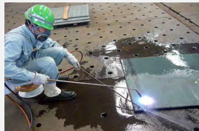
船舶外板の熱加工
