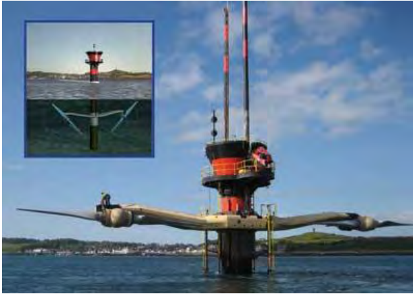
MCT SeaGen Tidal Turbine (MCT HPより引用)
