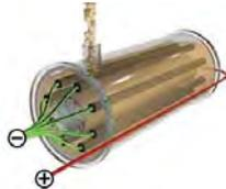
廃水処理のための微生物燃料電池
