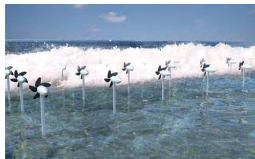
並んだ小型の波力発電機は、砕け散る波から生じる渦の流れを利用して発電する。(イメージ図)
