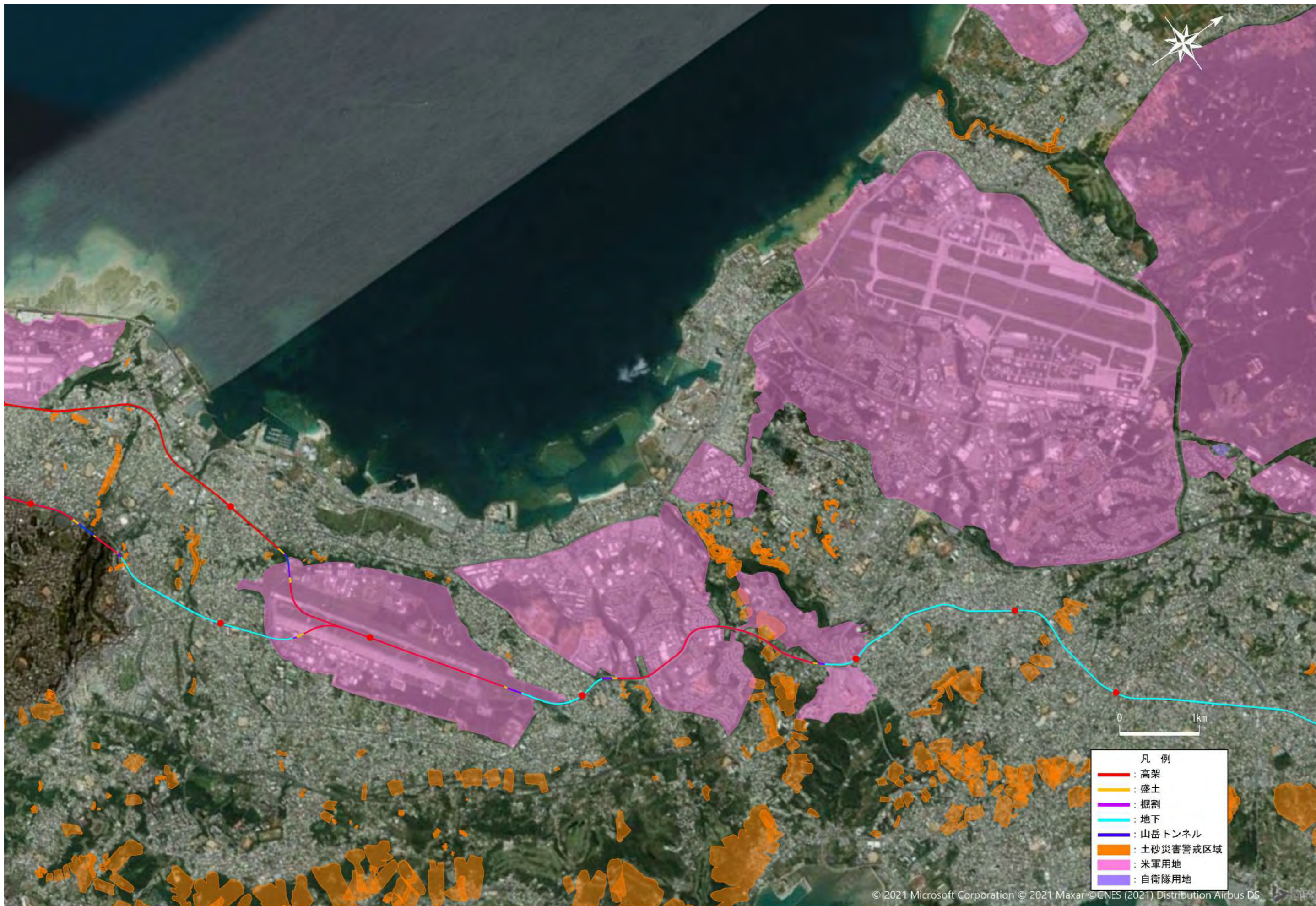
図 土砂災害警戒区域等を重ね合わせた線路平面図（その2）
