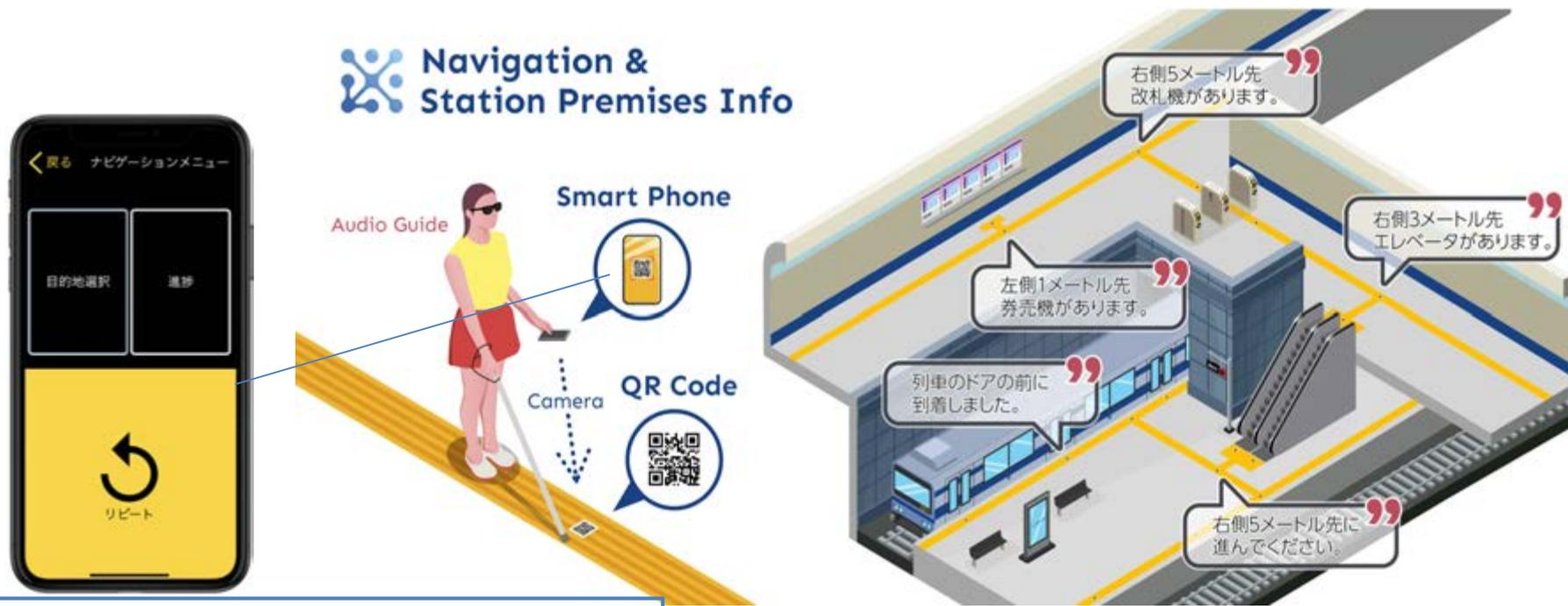
「shikAI」は、駅構内の点字ブロックにQRコードを設置し、スマホのカメラで読み取ることで、現在地から目的地までの駅構内の移動ルートを導き出し、音声で目的地までご案内するシステム
