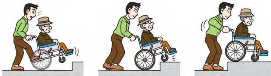
段差の手前で、ステッピングバーを利用し前輪を浮かせます。
