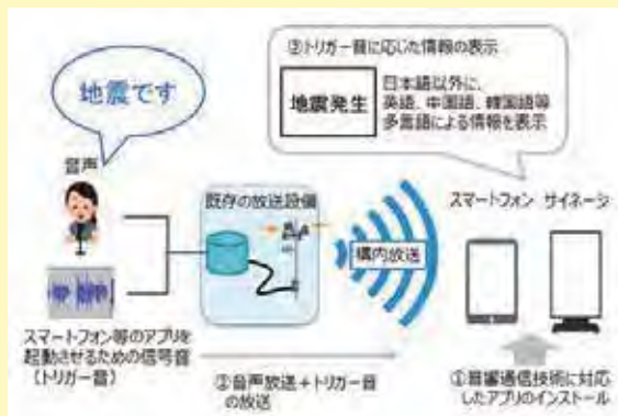
音響通信技術を用いた避難誘導等の情報伝達イメージ
