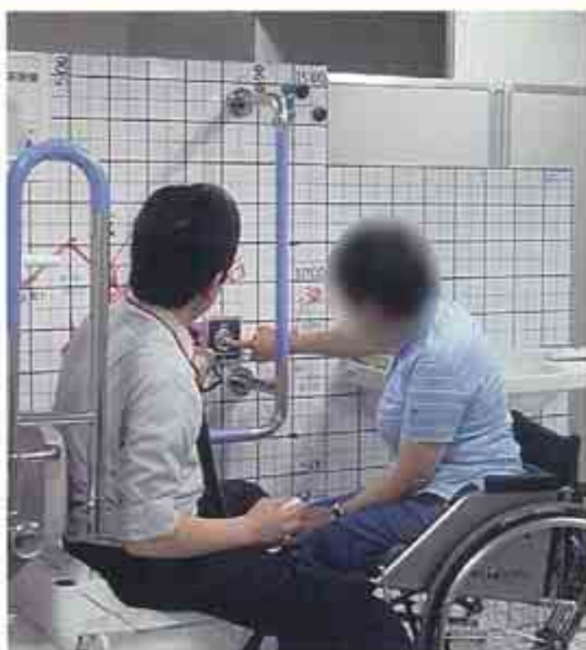
水洗ボタン等の検証の様子
