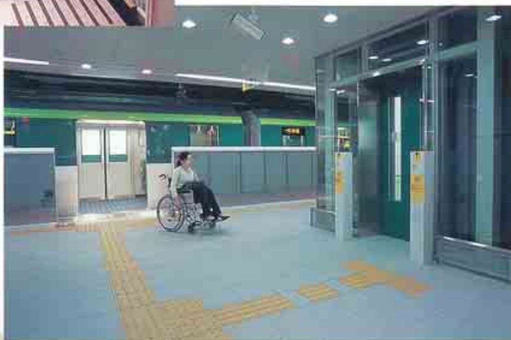
ホーム中心付近のエレベーターとボタンが押しやすいスイッチ
