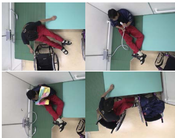
多目的シャワールームの実寸モデルを用いたモニター調査
