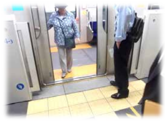
ホームと車両間の段差・隙間の縮小
