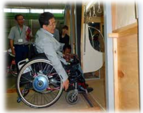
車両モックアップ（段差の確認）
