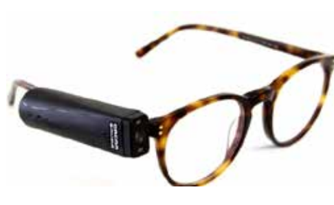
AI視覚支援デバイス(オーカムマイアイ) 内蔵カメラに映った文字を読み上げる。 顔の認識や紙幣の認識等も可能。
