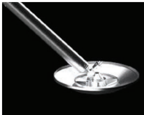
図 4-2 本人工衛星のフットパッドの外観
