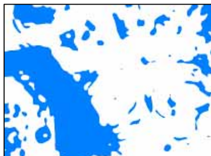
ステレオ方式による障害物検知(青) (急斜面、クレータの検知)
