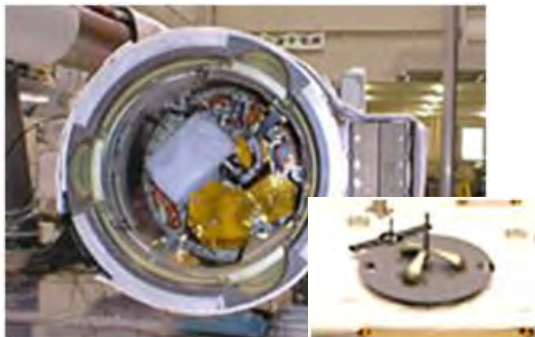
スペースシャトル・ISSで標準のカナダ製ハンド機構と取っ手
