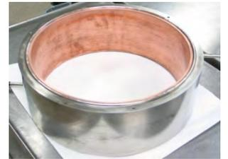
HIP (Hot Isostatic Pressing) ろう付け
