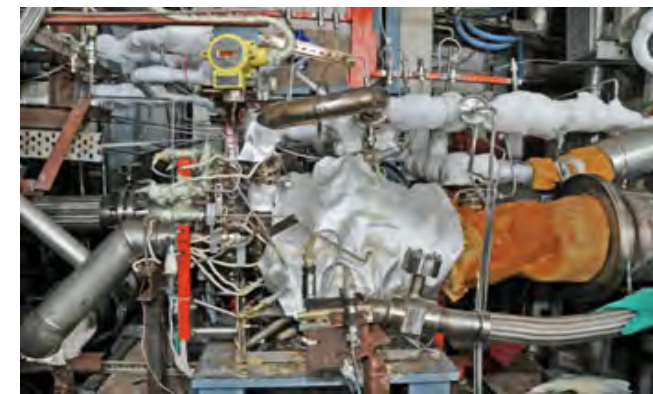
CE20統合ターボポンプ試験状況
