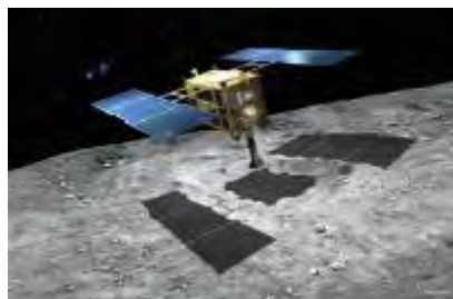
衝突装置によって作られた人工的クレーターの内部からの物質採取に挑む
