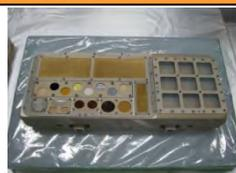
8.5ヶ月の曝露実験後、回収された微小粒子捕獲・材料曝露装置(JEM/MPAC&SEED)
