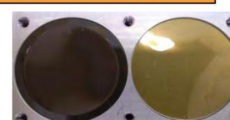
紫外線や原子状酸素等による宇宙用材料の劣化評価
