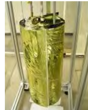
熱制御材料の性能評価 (多層断熱材の実効放射率精密測定)
