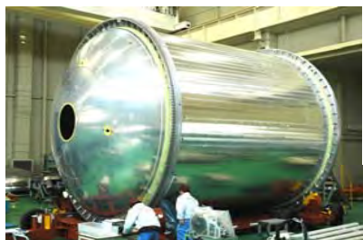
H-IIロケット用 大型タンク供試体 (直径5.2m)
