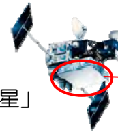
PALSAR フェーズドアレイ方式 Lバンド合成開口レーダ
