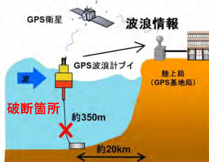
GPS波浪計( )ブイによる波浪観測システム
