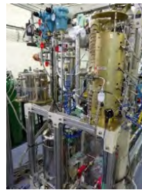
CO 2 還元地上実証装置
