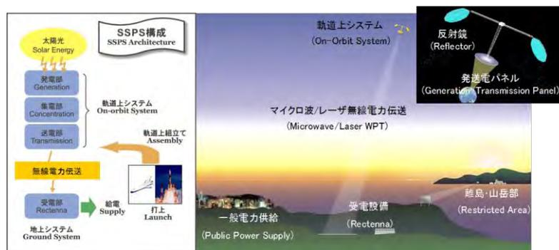
図1 宇宙太陽発電システム
