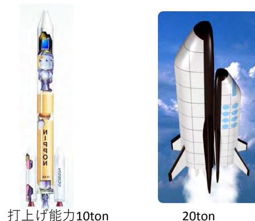
図3 H-IIA ロケットと再使用型輸送機 (TSTO)
