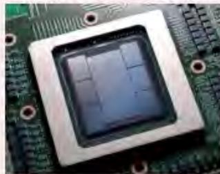
世界初となるCPUと6個の3次元積層メモリHBM2搭載技術をTSMC社と共同開発
